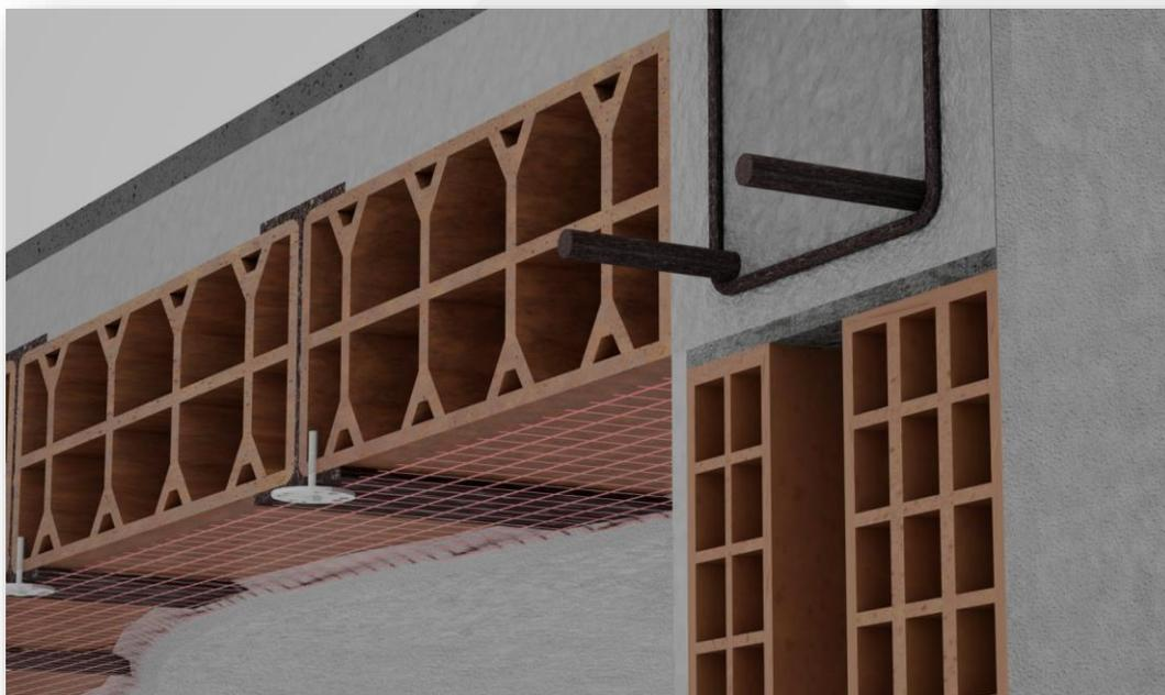
Anche per i solai in putrelle e tavelloni è stata certificata la tenuta del sistema **OLYMPUS SAFE** realizzato con **rete in fibra di vetro GFRP alcali resistente OLY MESH 250** ed un apposito sistema di connessione.
