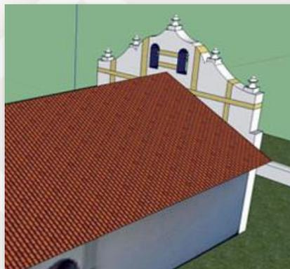
Per evitare il ribaltamento fuori dal piano della parte sommitale della facciata sono state applicate fasce verticali in fibra di aramide sia sul prospetto anteriore che posteriore della facciata, collegate alle estremità alla muratura con trefoli in fibra di aramide.
