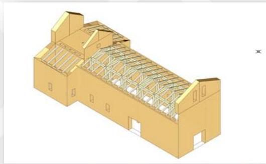
La modellazione della struttura ha evidenziato la compatibilità dei risultati con la modellazione a macroelementi soprariportata. A valle dell'analisi effettuata è stato quindi possibile dimensionare gli interventi di consolidamento che sono stati progettati con fibra di aramide AFRP **OLY TEX ARAMIDE** utilizzando il software di calcolo per sistemi di consolidamento FRP "**OLY MASONRY APP**".
