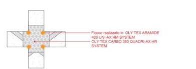
Flocco realizzato in OLY TEX ARAMIDE 400 UNI-AX HM SYSTEM e OLY TEX CARBO 380 QUADRI-AX HR SYSTEM
