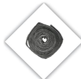
*OLY ROPE BASALT* es un elemento estructural circular fabricado con fibra de basalto, conforme a la norma CNR DT 200 RI/2013, que consiste en compuesta por filamentos mono direccionales que; se utiliza ampliamente en la consolidación de estructuras de edificios nuevos e históricos-monumentales, para la creación de clavos, cadenas, refuerzos al intradós de bóvedas, refuerzo de mampostería o anclajes en mampostería. El cordón está disponible en los diámetros 6-8-10-12.
