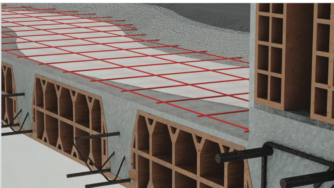
Al fine di ottenere la solidarizzazione tra la nuova soletta in calcestruzzo e l'impalcato esistente **Olympus®** ha ingegnerizzato e qualificato un sistema di connessione chimica realizzato mediante l'utilizzo di una resina epossidica a media viscosità applicata all'estradosso del solaio prima del getto della nuova soletta.
