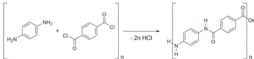
La produzione è simile ad altre fibre polimeriche: polimerizzazione, estrusione, stiramento. Il polimero viene sciolto in un liquido ed estruso ad una temperatura di circa 200 °C mentre evapora il solvente. L'estrusione può avvenire soltanto dalla soluzione in quanto il punto di fusione della fibra è molto più alto della temperatura
