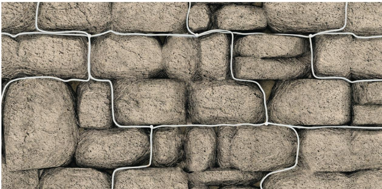
Questa tecnica può essere utilizzata sia per rinforzare il singolo pannello in muratura, sia per rinforzare un interno manufatto realizzando anche un efficace collegamento tra murature trasversali grazie alla continuità dei cavi in acciaio che vanno ad armare i giunti di malta.
