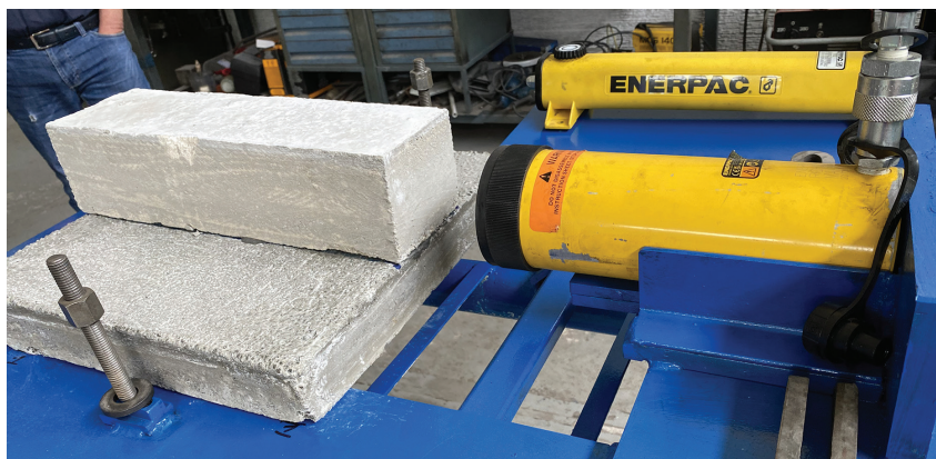
Prova su travetto in calcestruzzo
