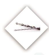
OLY CHAIN 304/316 è una barra elicoidale in acciaio INOX AISI 304/316 trafilato a freddo ad elevate prestazioni meccaniche adatta per la stilatura armata dei giunti e per le connessioni da un lato o passanti su muratura, calcestruzzo armato, archi e volte.
