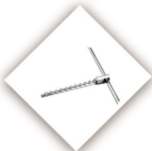
**OLY CONNECT FACCIA VISTA** è un dispositivo per il collegamento trasversale della barra elicoidale **OLY CHAIN** di diametro 8 o 10 mm ed il trefolo in acciaio **OLY ROPE 3/5 AISI 316** nel sistema **OLYMPUS FACCIA VISTA**. È dotato di due fori di diametro 6 mm per il collegamento simultaneo di due cavi in acciaio inox. Il dispositivo presenta una strozzatura per il serraggio della barra **OLY CHAIN**.
