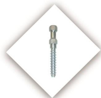
**OLY CONNECT FLOOR C.A.** è il connettore a secco per soletta ribassata, con testa di soli 27 mm per calcestruzzi con spessore almeno di 30 mm. Il connettore a secco con testa ribassata viene impiegato per il consolidamento di solai esistenti. Il connettore a secco migliora la tecnica di connessione dei solai latero-cementizi sotto gli aspetti di praticità, semplicità ed economia.
