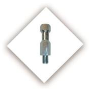
OLY CONNECT FLOOR STEEL è composto da un unico perno in acciaio di diametro 16 mm, con parte inferiore di lunghezza 15 filettata UNI5737 M12×1.5×20 auotmaschiante connessione meccanica con il profilo d'acciaio, con battuta di fine corsa e parte superiore di altezza standard di 27 mm (variabile in funzione dello spessore della soletta collaborante), sagomata con scanalatura di aggrappo alla cappa di calcestruzzo.
