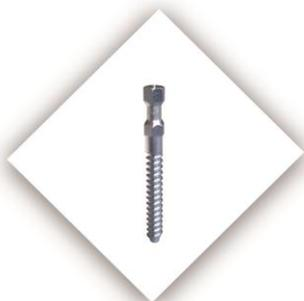
**OLY CONNECT FLOOR WOOD** è il connettore a secco per soletta ribassata, con testa di soli 27 mm per calcestruzzi con spessore almeno di 30 mm. Il connettore a secco con testa ribassata viene impiegato per il consolidamento di solai esistenti in legno. Il connettore a secco migliora la tecnica di connessione dei solai in legno sotto gli aspetti di praticità, semplicità ed economia.
