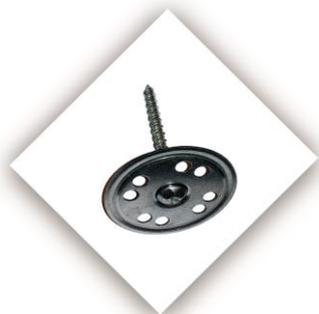
**OLY CONNECT SAFE C.A.** è un connettore adatto al fissaggio di reti preformate per sistemi antisfondellamento. Il connettore in acciaio zincato è composto da una vite avente dimensioni 7,5x100 mm ed una rondella con fori per migliorare l'aggrappo, avente diametro esterno 70 mm.
