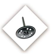
OLY CONNECT SAFE STEEL è un connettore adatto al fissaggio di reti preformate per sistemi antisfondellamento. Il connettore in acciaio zincato è composto da una vite avente dimensioni 8x60 mm ed una rondella con fori per migliorare l'aggrappo, avente diametro esterno 70 mm.
