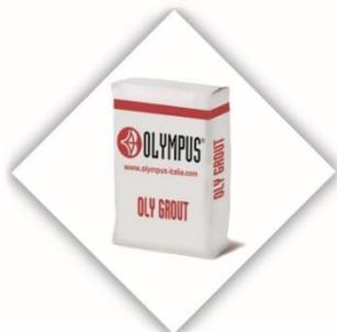
**OLY GROUT MX** è una malta da ripristino tixotropica a presa rapida e a ritiro controllato idonea per il risanamento del calcestruzzo ammalorato. OLY GROUT MX è una malta composta da leganti idraulici resistenti ai solfati, aggregati selezionati, fibre sintetiche ad alte prestazioni ed additivi che conferiscono un'ottima reologia pastico-tixotropica e garantiscono un'elevata adesione al supporto. OLY GROUT MX è conforme alla normativa europea EN 1504-3 classe R4.
