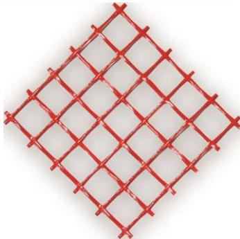
**OLY MESH CORNER GLASS 33X33** è un elemento angolare preformato in fibra di vetro impregnato con resina termoindurente. È adatto all'esecuzione di interventi di rinforzo strutturale su edifici esistenti con la tecnica dell'intonaco armato CRM (Composite Reinforced Mortar). È un componente del sistema OLY MESH GLASS 33X33 CRM SYSTEM, certificato C.V.T. ai sensi della Linea Guida CRM:2019.
