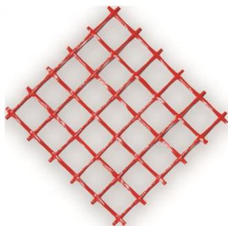
**OLY MESH GLASS 250** è una rete preformata bidirezionale in fibra di vetro adatta per la realizzazione di presidi antisfondellamento. Tra i vantaggi è rapida e facile da applicare, è leggera, ha uno spessore ridotto ed è molto maneggevole. Presenta ottime caratteristiche. È facile da tagliare; duratura; non arrugginisce; compatibile con tutti i supporti, è utilizzabile sia con malte a base di calce che cementizie.
