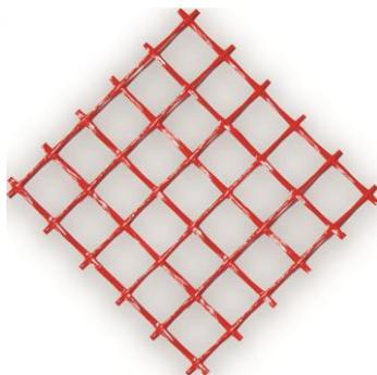
**OLY MESH GLASS G330** è una rete preformata in fibra di vetro impregnata con resina termoindurente. È adatta all'esecuzione di interventi di rinforzo strutturale su edifici esistenti. La rete è marcata CE ai sensi norma EAD 340392-00-0104 ed in possesso di ETA (European Technical Assessment) n. 23/0758.
