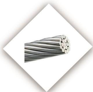
**OLY ROPE 5 AISI 316** è un trefolo in acciaio inossidabile AISI 316 a 133 fili, di diametro 5 mm, per il consolidamento delle murature con il sistema della ristilatura armata dei giunti chiamato **OLYMPUS FACCIA VISTA**. Questo sistema consente di migliorare le caratteristiche meccaniche delle murature da mantenere a vista, fornendo un efficace confinamento senza alterare l'aspetto estetico del manufatto.
