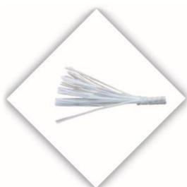
**OLY ROPE GLASS AR** è un elemento di rinforzo strutturale FRP a sezione circolare costituito da filamenti monodirezionali di vetro che vengono messi insieme a costituire un “trefolo”; è ampiamente utilizzato nel consolidamento di strutture di edilizia, sia nuova che storico-monumentale, per la realizzazione di chiodature armate, catene, rinforzo intradossale di volte, rinforzo di murature o ancoraggi sulle murature.
