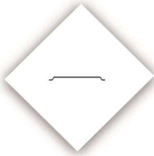
**OLY STEEL FIBER 35-30** è ottenuta mediante trafilatura a freddo del filo d'acciaio ad alto contenuto di carbonio. Il filo viene leggermente laminato durante la fase di taglio e viene eseguita una sagomatura ad uncino alle estremità della fibra stessa per migliorare l'adesione all'impasto. La fibra OLY STEEL FIBER 35-30 è marcata CE per uso strutturale in accordo alla norma EN 14889-1 e può essere additivata a calcestruzzi e malte premiscelate nel dosaggio previsto dalle relative istruzioni.
