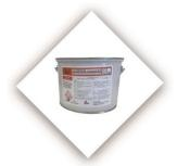
OLY RESIN 10 è uno stucco epossidico bicomponente tixotropico a base di resine epossidiche senza solventi, fornito in confezioni predosate con rapporto resina-indurente 1:1. Presenta un'eccellente adesione a svariati supporti e non subisce ritiro nell'indurimento che avviene per reazione chimica senza emissione di sostanze volatili, è consigliato per l'incollaggio di sistemi FRP su supporti con asperità fino a 2 mm. OLY RESIN 10 è marcato CE come incollaggio strutturale secondo la EN 1504-4.
