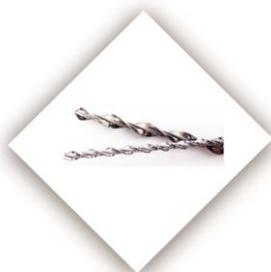
**OLY STEEL CHAIN 304/316** è una barra elicoidale in acciaio INOX AISI 304 o 316 ad elevate prestazioni meccaniche adatta per la stilatura armata dei giunti e per le connessioni da un lato o passanti su muratura e calcestruzzo armato. Facile da tagliare, idonea per interventi su edifici anche di interesse storico e culturale, può essere installata a secco o mediante inghisaggio con malte o resine. **OLY STEEL CHAIN 304/316** è marcata CE secondo la EN 845-1:2013 + A1:2016.
