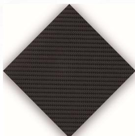
**OLY TEX CARBO 300 UNI-AX HM** (alto modulo) è un tessuto unidirezionale in fibra di carbonio di grammatura 300 g/m<sup>2</sup> ad alto modulo elastico specifico per gli interventi di consolidamento strutturale.
