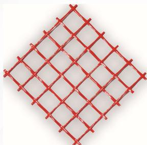
**OLY MESH GLASS 99X99** è una rete preformata in fibra di vetro impregnata con resina termoindurente. È adatta all'esecuzione di interventi di rinforzo strutturale su edifici esistenti con la tecnica dell'intonaco armato CRM (Composite Reinforced Mortar). È un componente del sistema OLY MESH GLASS 99X99 CRM SYSTEM, certificato C.V.T. ai sensi della Linea Guida CRM:2019
